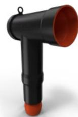
El conector tipo codo y la boquilla tipo inserto son los componentes esenciales para todas las conexiones de operación con carga, es una terminación desconectable totalmente sellada, para la conexión de cable subterráneo a transformadores, gabinetes de seccionamiento y cajas derivadoras equipados con boquillas de operación con carga.
