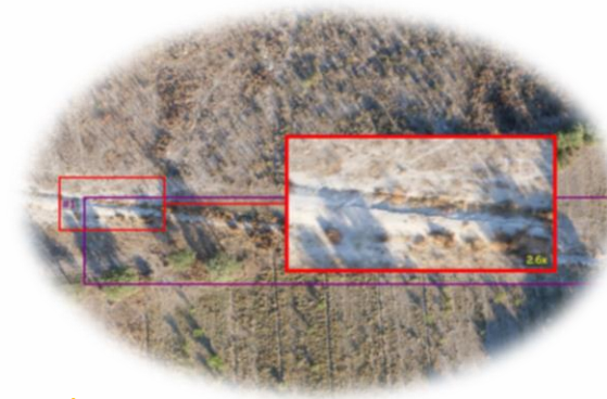
✓ Grietas a lo largo del derecho de vía en el terreno, sísmicamente activo.
